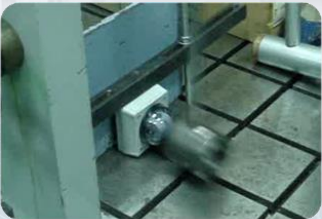
IK10 certifikace odolnosti proti úmyslnému poškození
