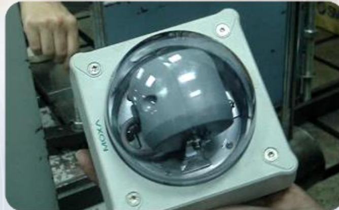
IK10 certifikace odolnosti proti úmyslnému poškození
